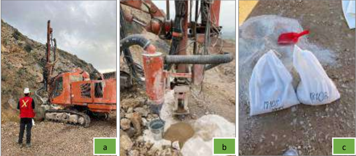
Şekil 49 Delici rok ile toz numune alma işlemleri (a, b, ve c).
