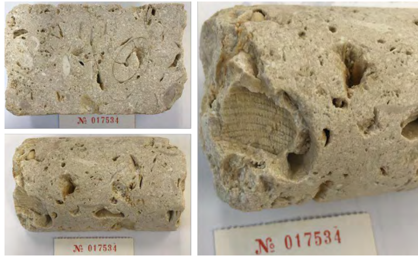
Şekil 68 MD-1 sondaj kuyusu, 125.50 - 125.60 m, 17534 no' lu örnekte görülen biyoklastlar ve erime boşlukları.
