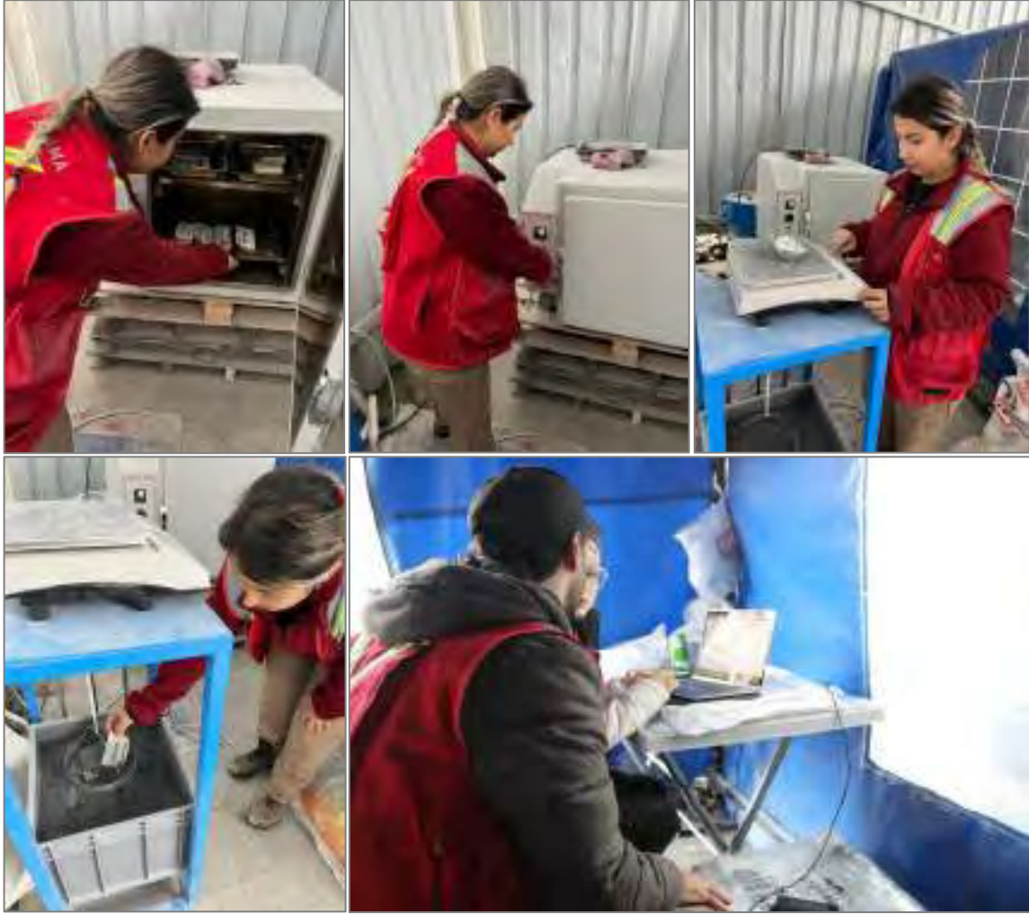
Şekil 64 Yoğunluk örneklerinin hazırlanması.
