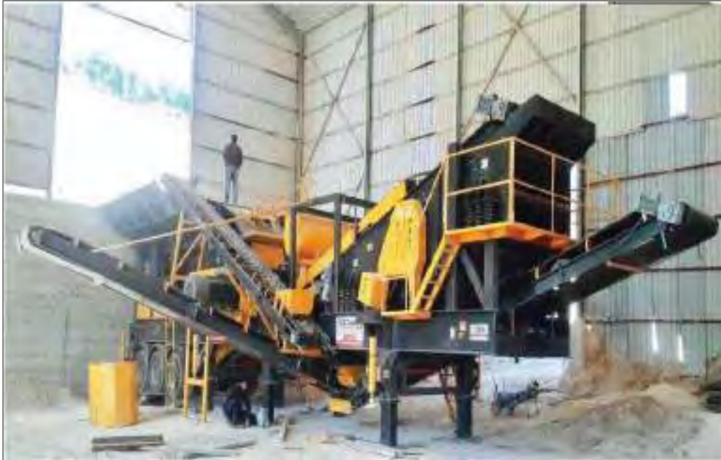
Şekil 110 Kırma Eleme Tesisi Görüntüsü.
