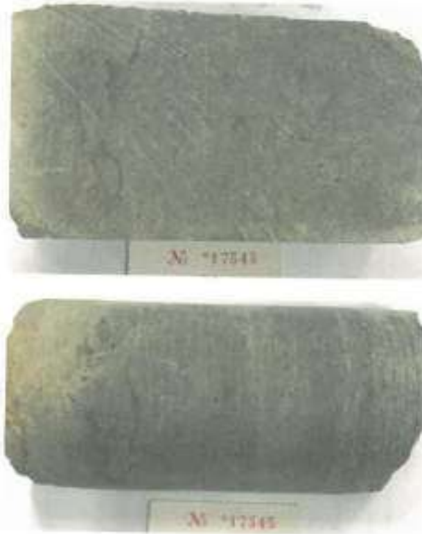
Şekil 4. 17545 nolu örnekte görülen pelespod kavkılar ile kahverenkli damarcıklar
