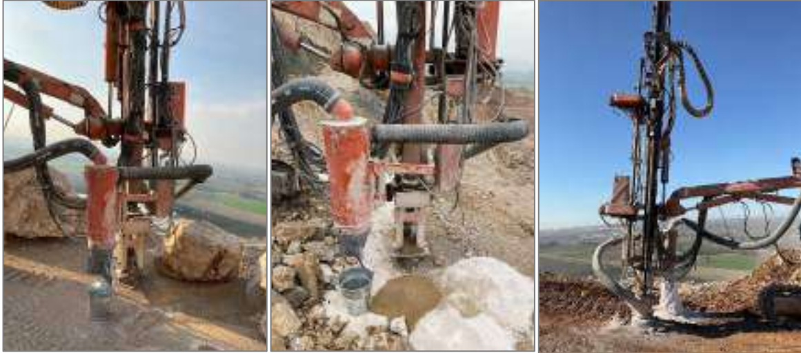
Şekil 48 Sandvık (Tam rock) DX700 makinası.
