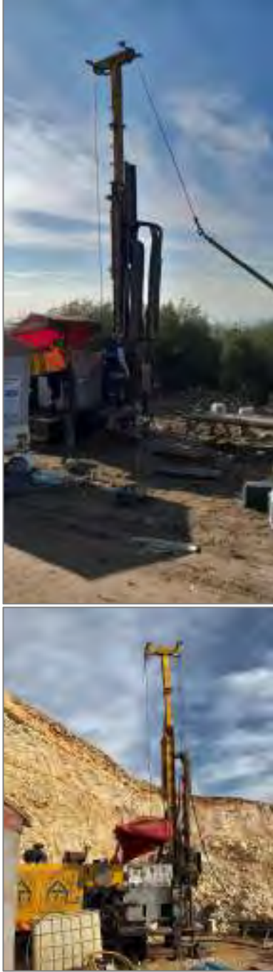
Şekil 57 Üstten döner sondaj makinası, ekipman ve malzemeleri (a: Tij, b: Karotiyer, c: çamur pompası, d: çamur karıştırıcı, e: karot sandıkları, f: bentonit)
