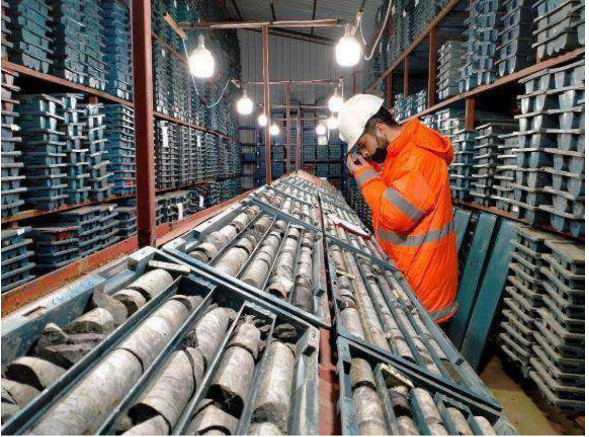
Foto 14 : Sondaj Karotları Loglama Çalışması
