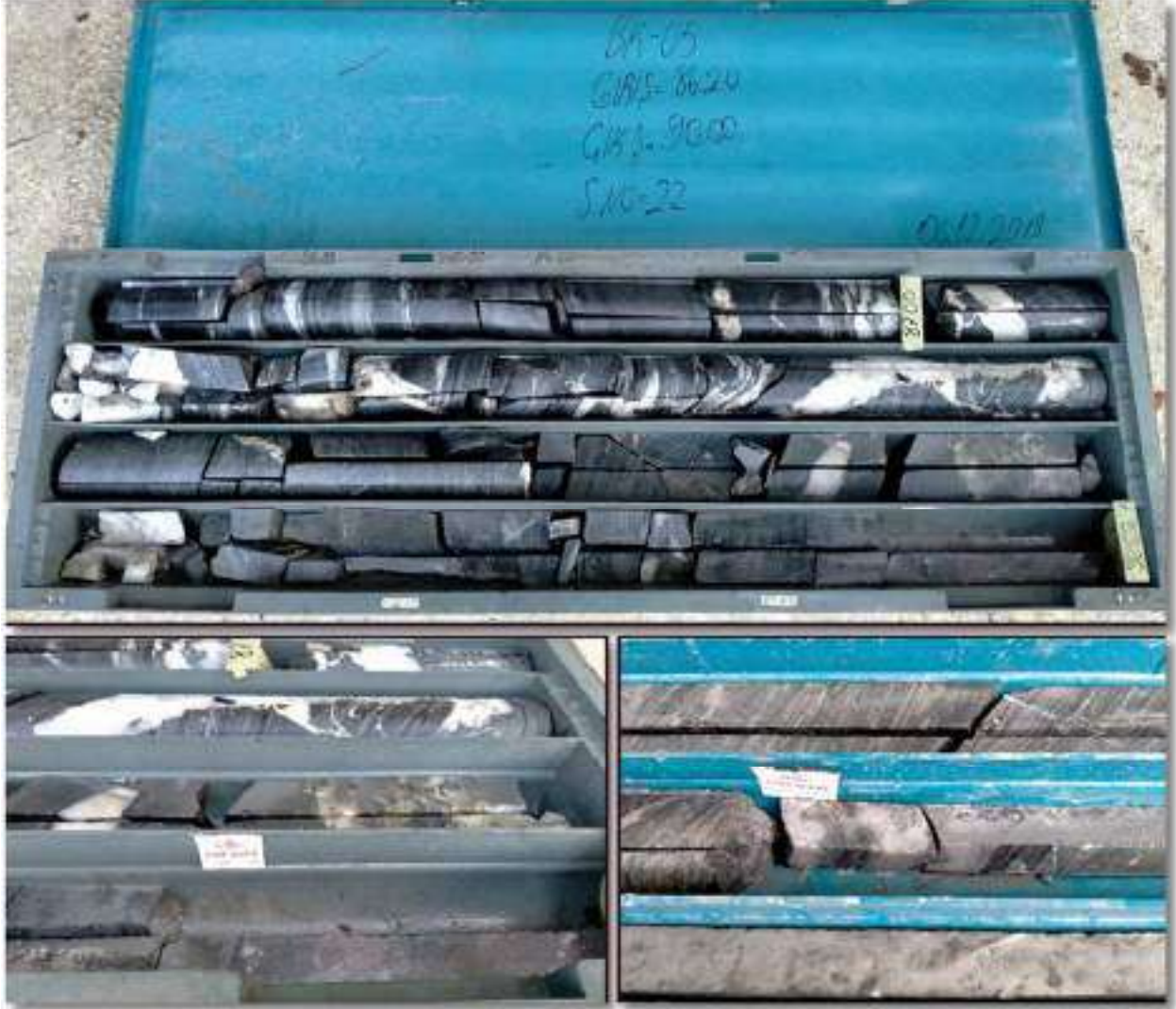
Foto 8: Kimyasal Analiz için Örneklelenen Sondaj Karot Örneği
