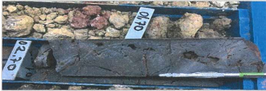
Şekil- 52. Oksitlenmiş Mineral Gösteren Karot Kutusu
