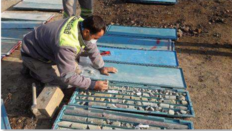
Foto 9: Sondaj Karotları Örneklemeye Çalışması
